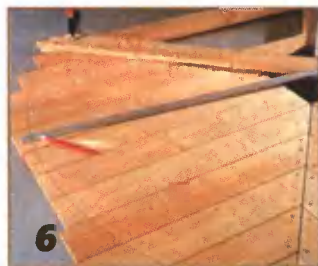
После разметки формы стола доски столешницы обрезают лобзиком.
