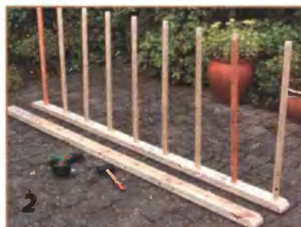
Концы стержней перед сборкой лестницы затёсывают. Стержни загоняют в отверстия лёгкими ударами резинового молотка.
