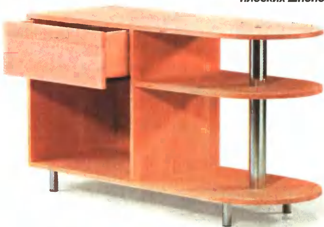
Для соединения столешницы и опоры поворотного стола их кромки запиливают «на ус» и склеивают с применением плоских шпонок-«бисквитов».
