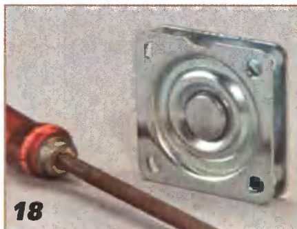
18 Шарнир поворота внешнего стола представляет собой вращающиеся на подшипнике две стальные квадратные пластины с отверстиями крепления.
