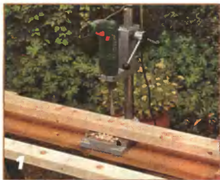
Изготовление «шведских» стенок начинают со сверления глухих отверстий в косоурах под стержни-ступени.
