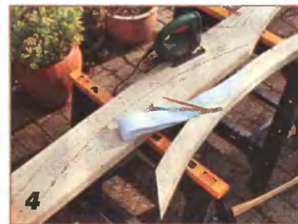
Дугообразные консоли выкраивают из широких досок. Шаблон в масштабе 1:1 вырезают, ориентируясь на рис. 1.
