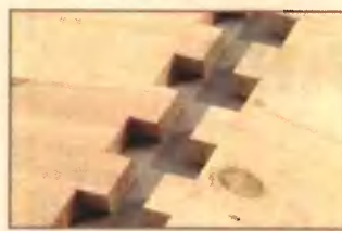
Рис. 4. Прямые открытые шипы можно нарезать вручную или с помощью устройства для фрезерования шипов.
