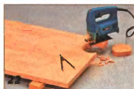
22 Под колёса поворотного стола вырезают ниши диаметром на 5–10 мм больше диаметра колёс.
