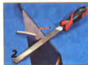
При подгонке деталей полки возможно придётся взяться за напильник.
