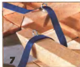
Для стягивания опорных брусков на их концах предусмотрены крючки.
