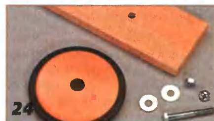
24 Обрезиненные колёса крепят болтами с гайками между двух планок, которые привинчивают к опоре поворотного стола.
