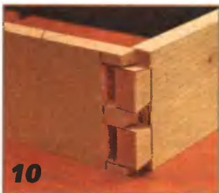
При соединении деталей по шипам и пазам осторожно постукивают молотком.
