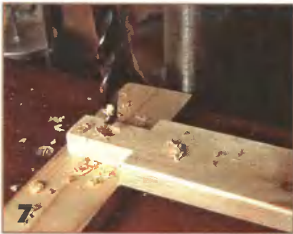
7 Чтобы отверстия были перпендикулярны поверхности детали, сверлить надо с применением стойки. До прямоугольной формы гнезда доводят маленькой стамеской.
