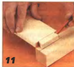
Приставить детали с совмещением заподлицо торца одной с кромкой другой и нанести карандашом контуры шипа.
