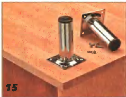
15 Трубчатые ножки приворачивают к нижней плите стола шурупами-саморезами.
