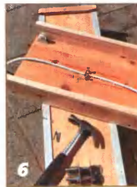
6 Резиновый шнур, пропущенный снизу платформы, служит для её притягивания.
