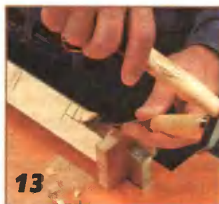
Закрепив деталь, стамеской выбрать паз.
