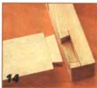
На полупотайной шип можно соединять и детали различной толщины.
