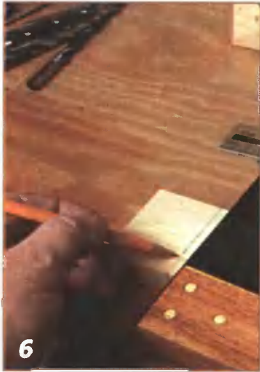
6 Разметка положения сквозных шипов для перемычек и стяжки.
