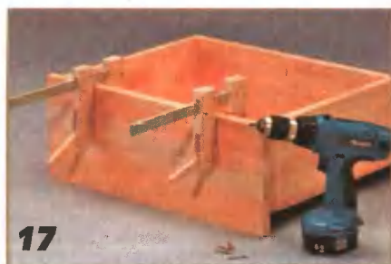
17 Фасадный щиток приклеивают, стягивая его с передней стенкой ящика до полного высыхания клея.
